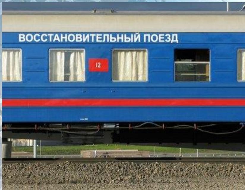
**Восстановительный поезд** — подразделение, предназначенное для ликвидации последствий сходов с рельсов подвижного состава, а также оказания помощи в пределах своих технических возможностей при ликвидации последствий происшествий природного и техногенного характера.
