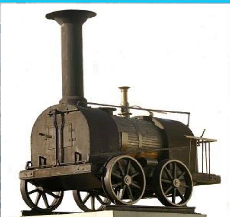
Первый паровоз «Сухопутный пароход» в России был построен отцом и сыном Е.А. и М.Е.Черепановыми в 1833 г. Этот паровоз перевозил до 3,2 т груза со скоростью около 16 км/ч, второй паровоз, построенный в 1835 г., мог возить груз уже в тысячу пудов (16,4 тонн) со скоростью 16,4 км/ч.
